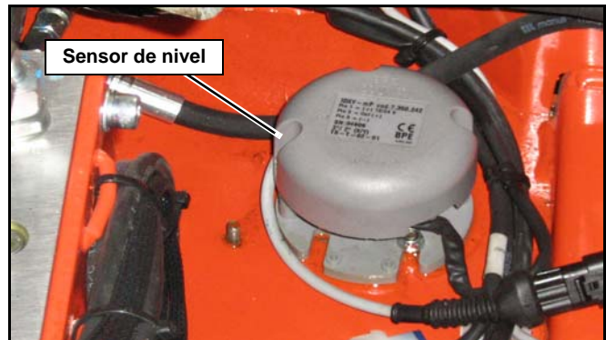
Figure 3: Ubicación del sensor de nivel
