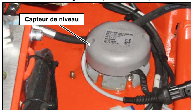
Figure 3 : Emplacement du capteur de niveau
