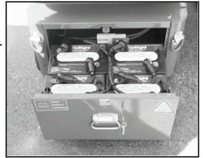
Abbildung 9: Zugang zu den Batterien
