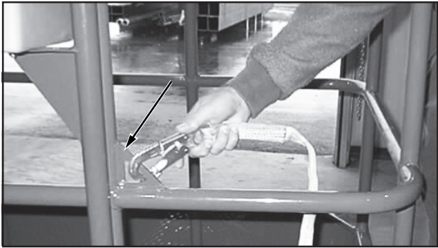
Figure 6 : Point de fixation type pour dispositif antichute
