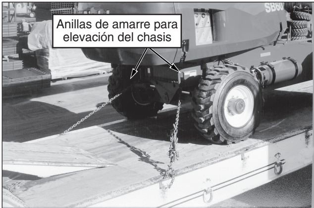
Figura 8: Anillos de amarre delanteros para elevación del chasis
