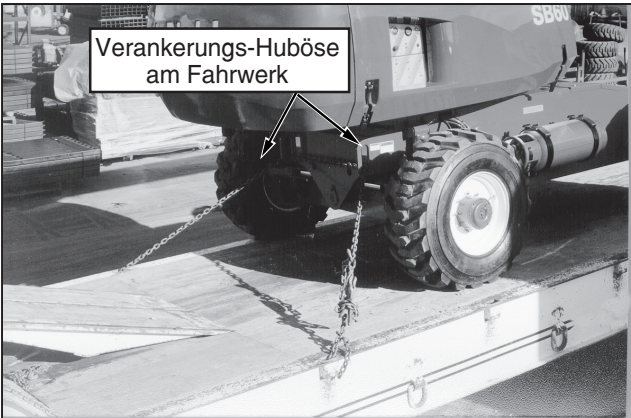
Abbildung 8: Vordere Verankerungs-Hubösen am Fahrwerk.
