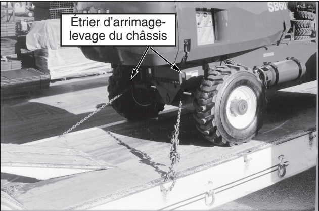
Figure 8 : Étrier d'arrimage-levage du châssis avant
