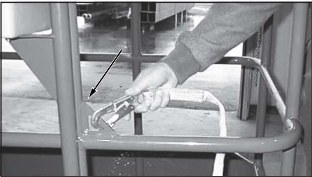
Abbildung 6: Typischer Verankerungspunkt für Haltegurte
