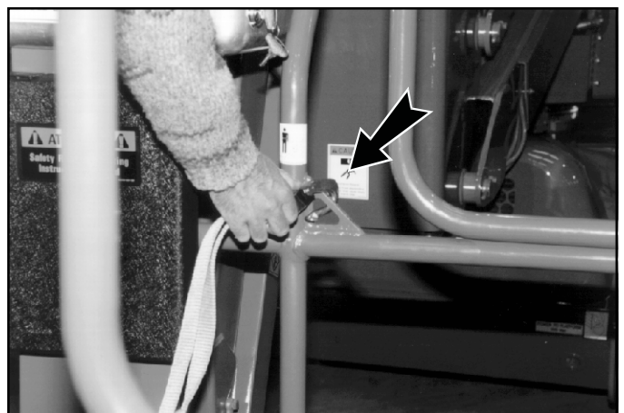
Abbildung 3: Typischer Verankerungspunkt für Haltegurte
