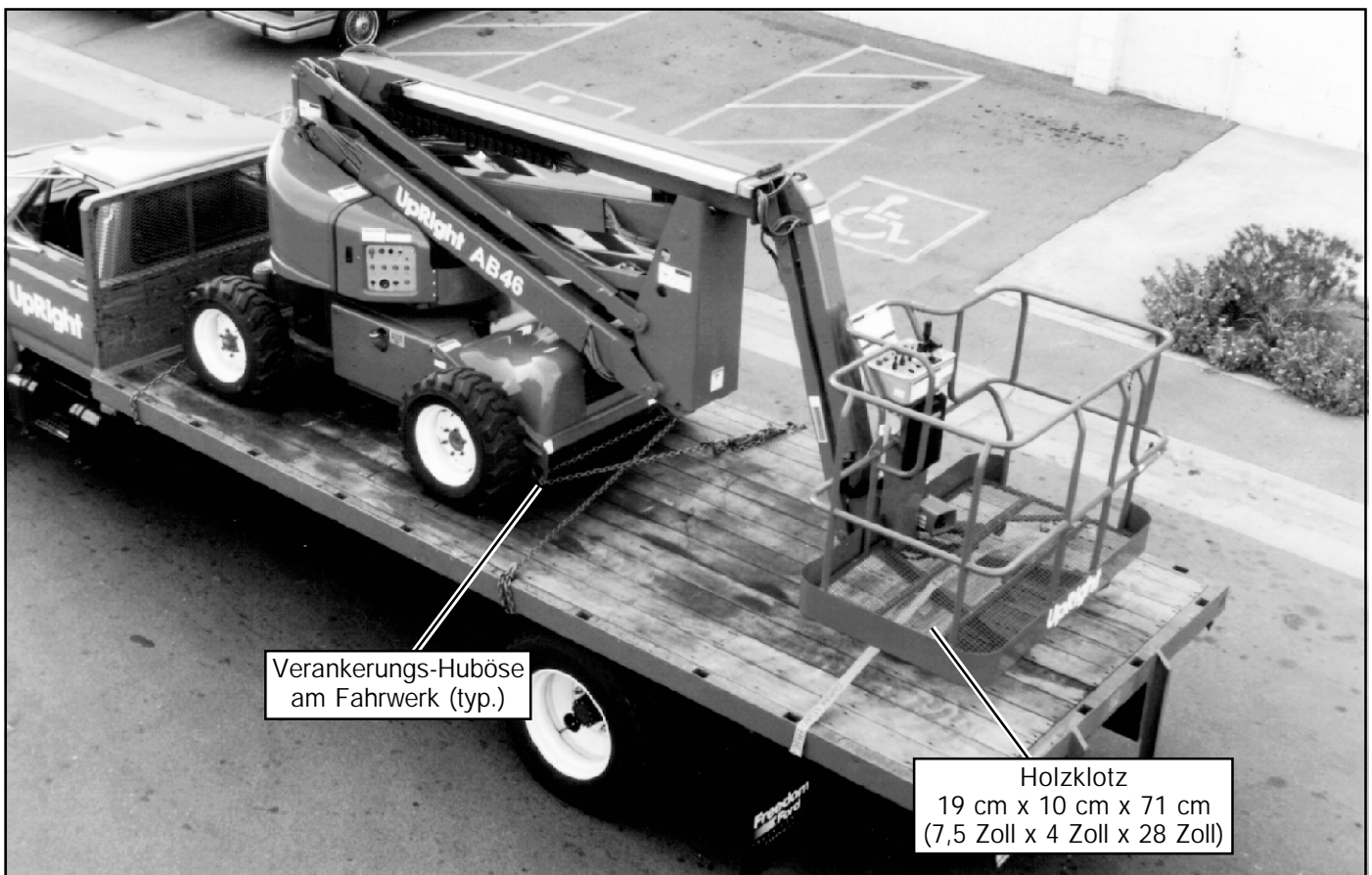
Abbildung 6: Sichern der Maschine für den Transport
