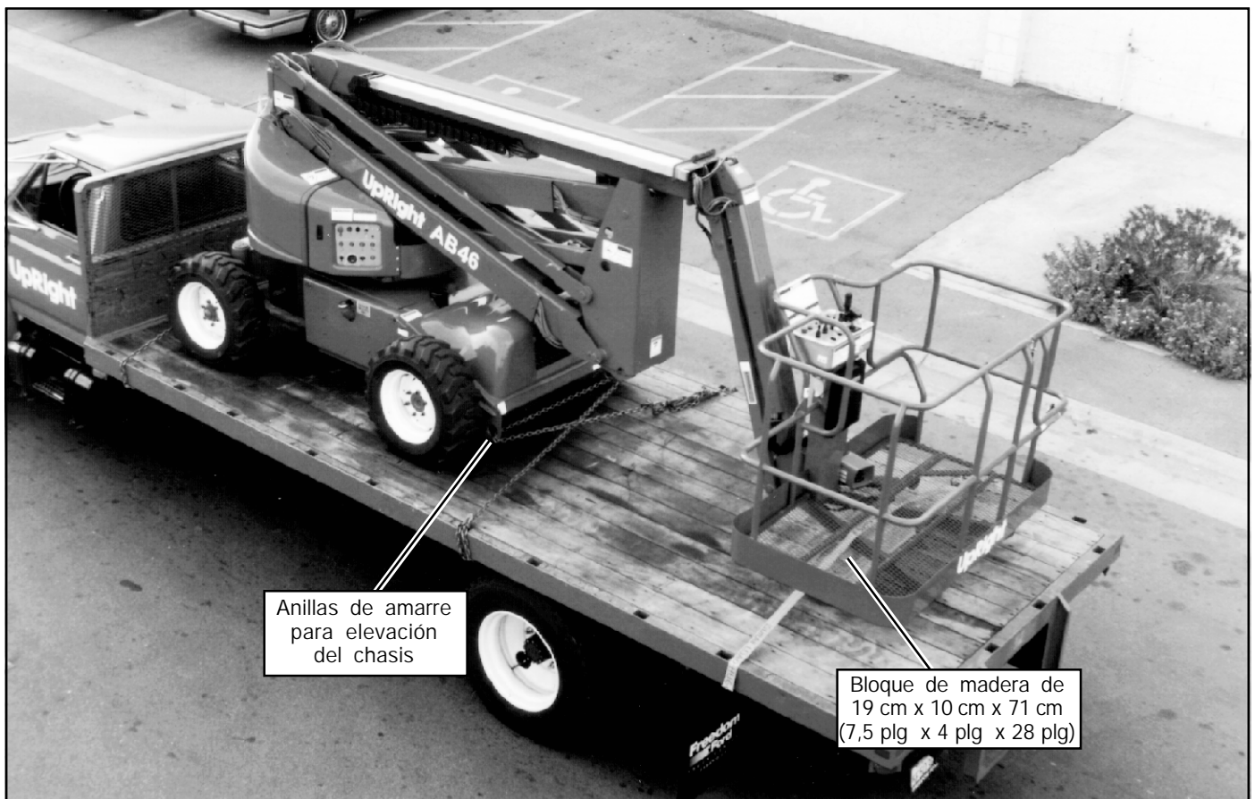
Figura 6: Cómo asegurar la máquina para el traslado
