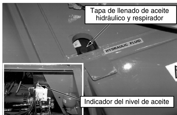
Figura 9: Tapa de llenado de aceite hidráulico y respirador e indicador de nivel de aceite
