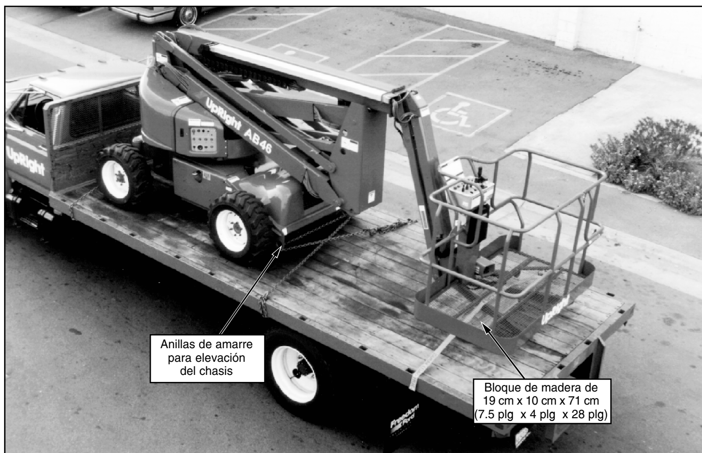
Figura 6: Cómo asegurar la máquina para el traslado
