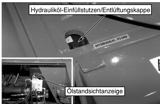
Abbildung 9: Hydrauliköl - Einfüllstutzen / Entlüftungskappe und Ölstandsichtanzeige
