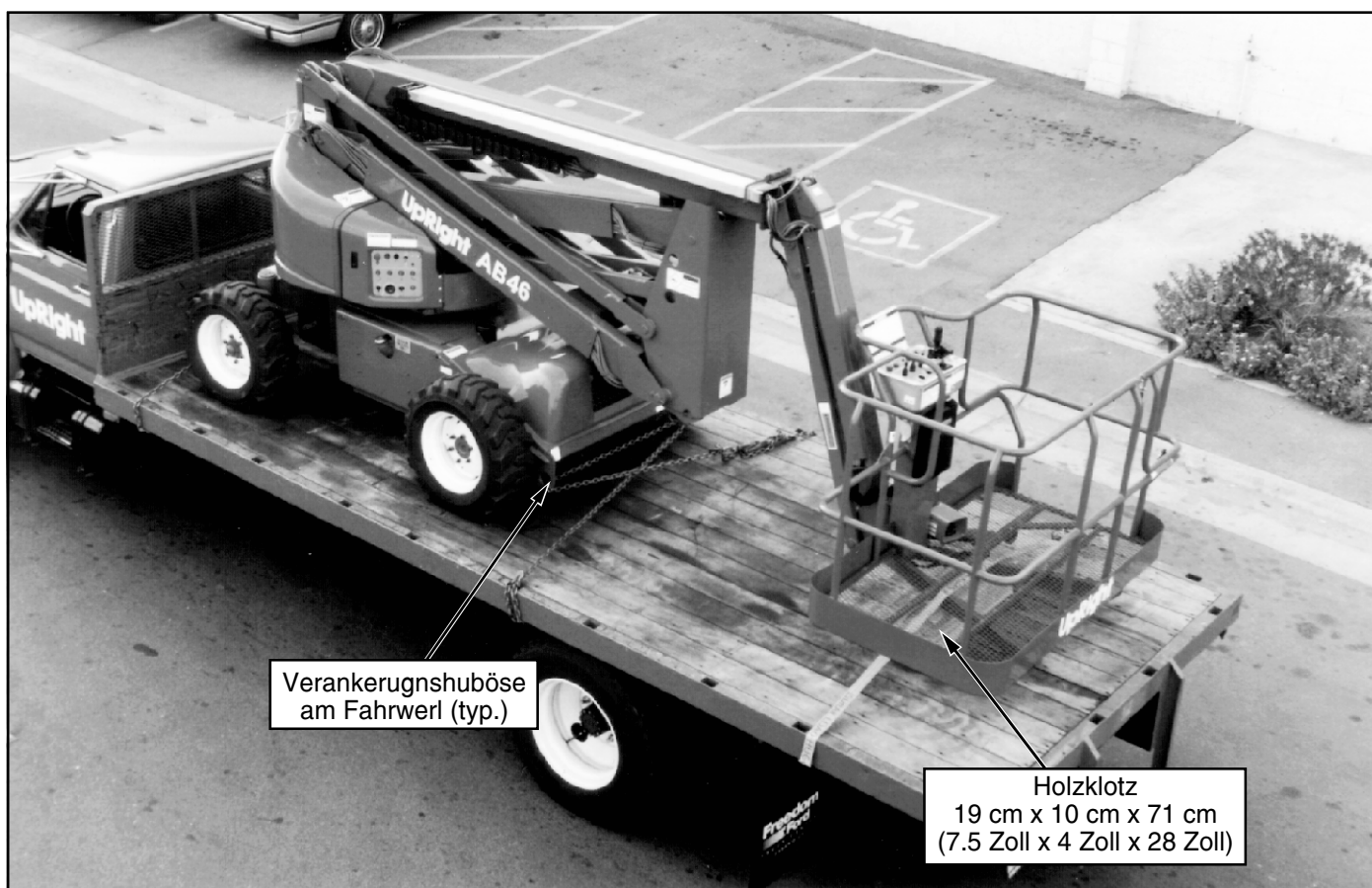
Abbildung 6: Sichern der Maschine für den Transport
