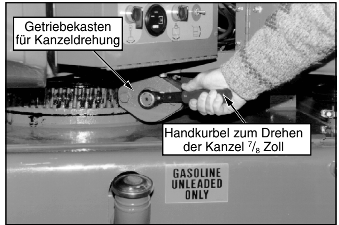
Abbildung 5: Drehen der Kanzel per Hand
