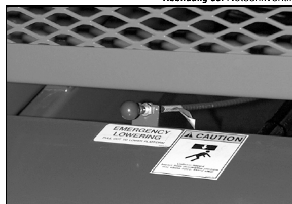
Abbildung 30: Notsenkventil
