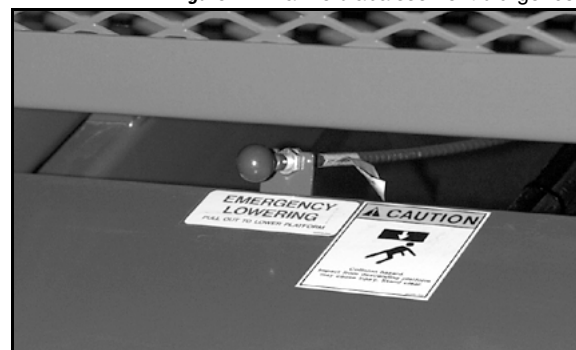
Figure 17 : Vanne d'abaissement d'urgence
