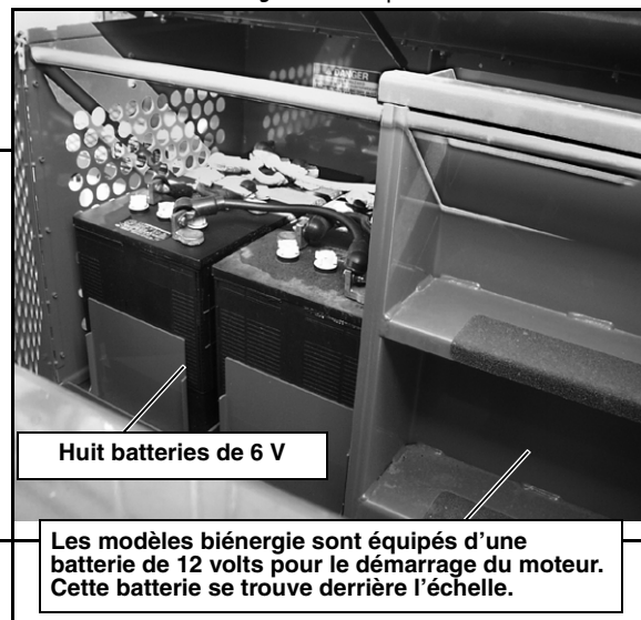
Figure 23 : Emplacement de la batterie
