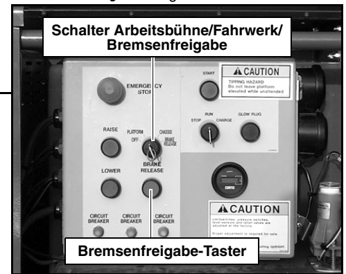
Abbildung 31: Freigabe der Feststellbremse
