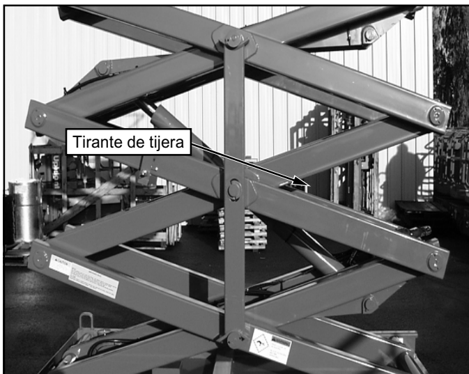
Figura 7: Bloqueando el mecanismo de tijera (X20N, X20W, X26N)
