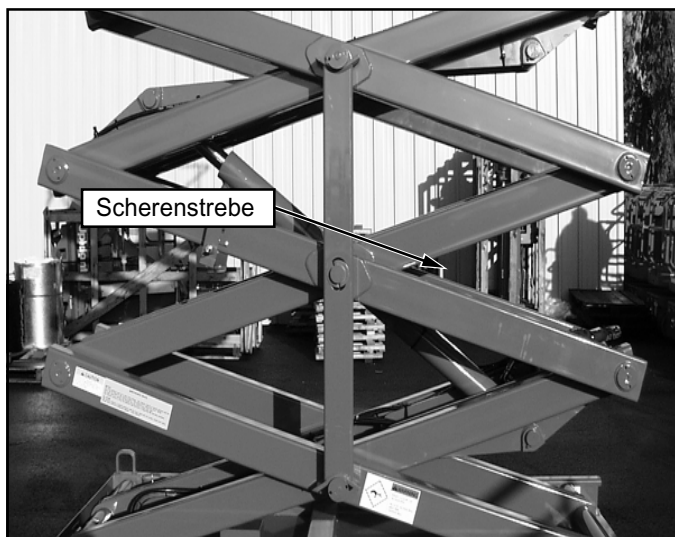
Abbildung 7: Blockieren des Hebeaufbaus (X20N, X20W, X26N)
