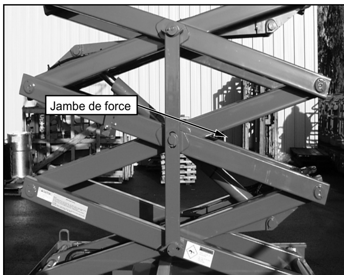
Figure 7: Étayage du dispositif d'élévation (X20N, X20W et X26N)
